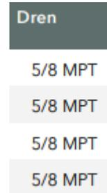
Imagen 02. Conexión que muestra el catálogo del dren de las charolas de condensado.
